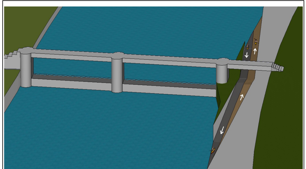
Figure 12: Le tapis roulant double sens qui permet aux canoë-kayaks de contourner l'écluse Réalisation: Alexandre Ahier
