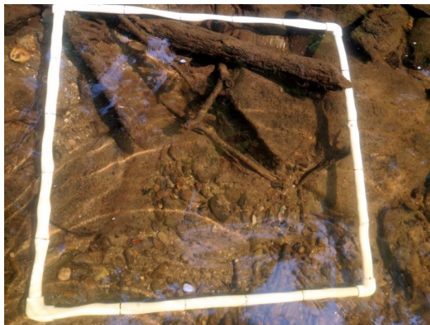
Figure 12 : Echantillonnages des données de substrat dans un quadra de 250cm²
