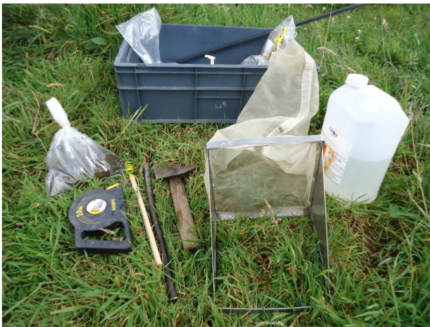
Figure 2 : matériel utilisé sur le terrain avec de gauche à droite : un sac plastique, un décimètre, un bâtonnet, un pieu, un marteau, un filet surbeur, un bidon de formol 3%.
