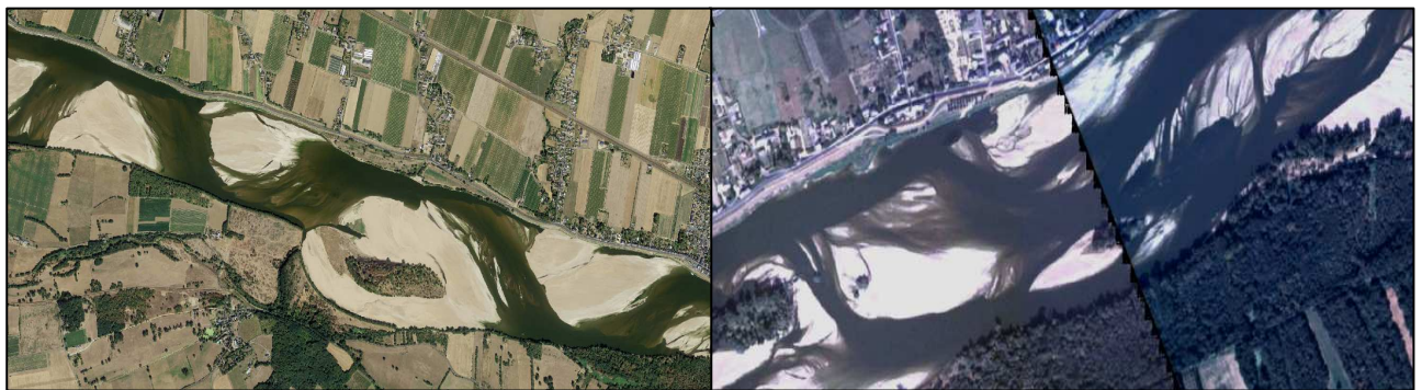
Fig. 1 : Barres alternes simple configuration sur le site de Saint-Mathurin en 2009 (a) et en configuration multiple sur le site de La Chapelle-sur-Loire en 1999 (b)
