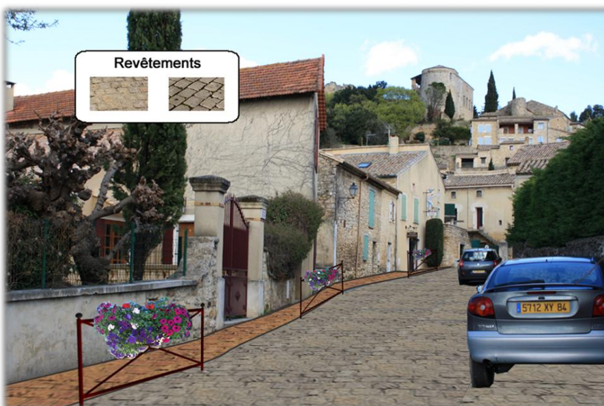
Figure 66 : Le bas de la Grand 'Rue après aménagement. Avec à gauche le cheminement piéton et à droite la voie recouverte de pavés pour ralentir les voitures et marquer l'entrée dans le centre du village.
