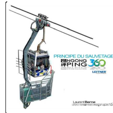
Figure 51: Cabines de sauvetage du 2S Ngong Ping 360, Chine
