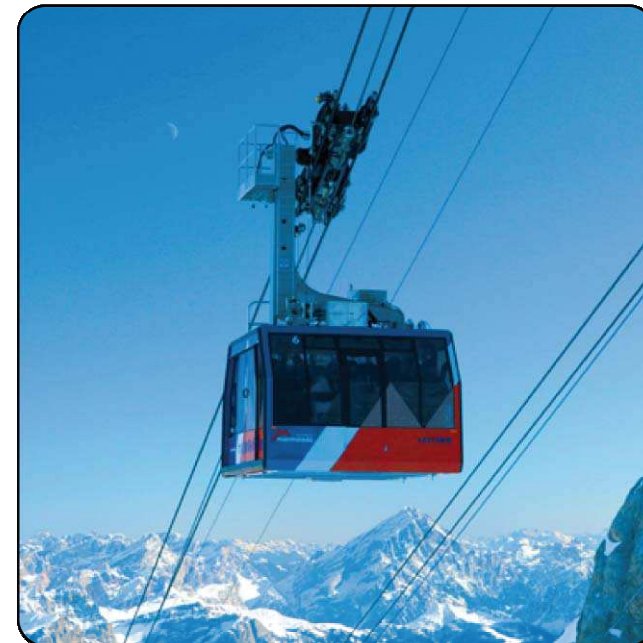
Figure 57: Téléphérique à va-et-vient, Source: Leitner
