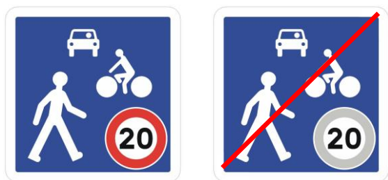
Photographie 28: Panneaux d'entrée et de sortie d'une "zone de rencontre"
