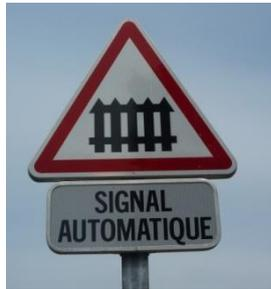
Photo 8 : Panneau indicateur de passage à niveau
