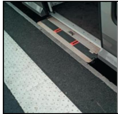
Photo 14 : Palette rétractable et bande podotactile pour PMR
