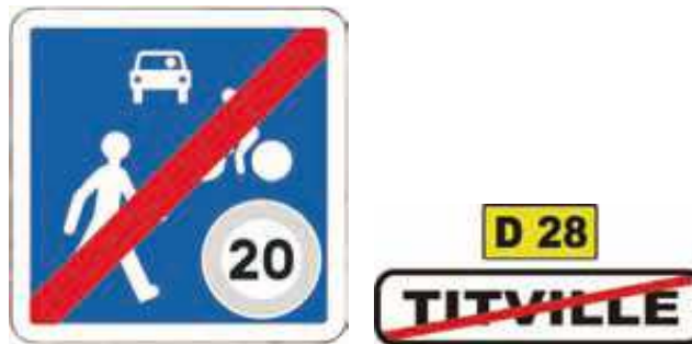
Figure 28 : Panneaux B53 et EB20 pouvant être mis à la sortie de la zone de rencontre
