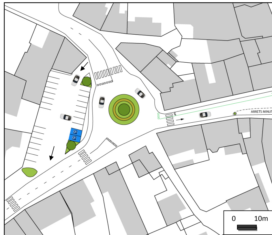
Figure 53 – Schéma de la future place Per Jakez Hélias et de la nouvelle intersection – Réalisation personnelle – Fond de carte : cadastre
