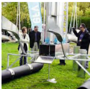
Illustration 1 : Pour lutter contre la prolifération d'une algue au lac de la Bergeonnerie, le choix s'est porté sur un brasseur d'eau alimenté par une éolienne.
