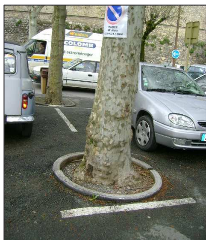
Arbre mal disposé par rapport à la place de parking
