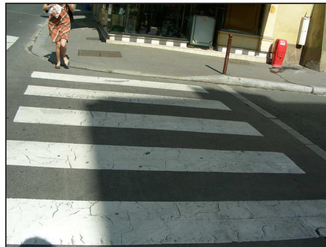
Passage piéton délimité à droite par une bordure noyée. Source: Photo personnelle.
