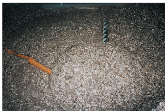
Silo de stockage des plaquettes forestières avec vis sans fin et bras articulés.
