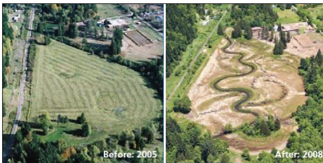
Figure 19 Exemple de re-méandrisation de rivière, Source: Bluegreencities.ac.uk
