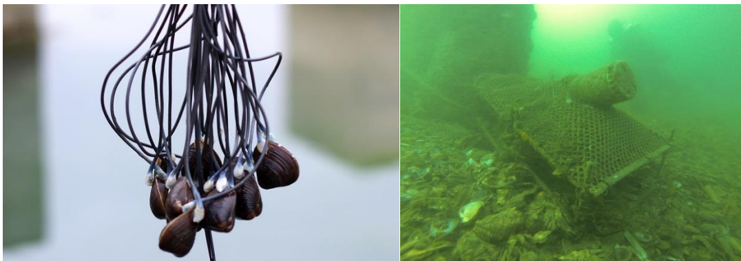
Figure 12 : Groupe de palourdes asiatiques équipé d'électrodes (à gauche). Cage dans laquelle sont protégées les bivalves durant l'expérience (à droite). © molluSCAN-eye®
