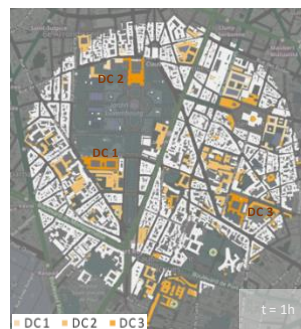
Bâtiments dont les besoins de chauffage sont satisfaits par la puissance récupérée des centres de données.
