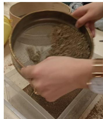
Figure 7 : Photographie lors de la méthode de prélèvement au tamis
