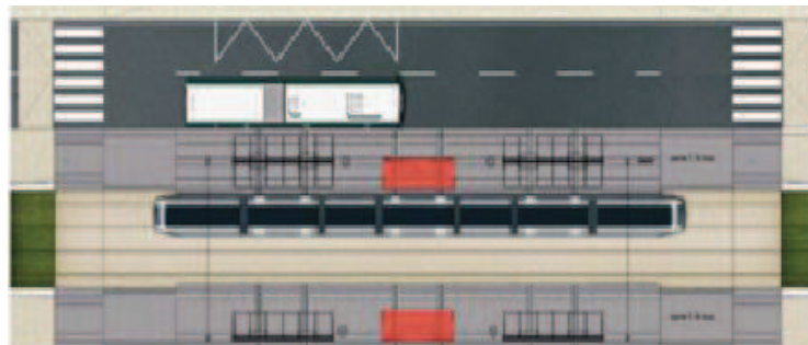
Figure 13 : Station partagée Tram/Bus (Sitcat, CitéTram)
