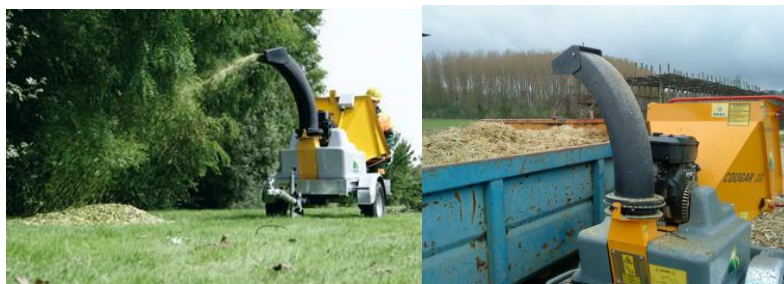
Figure 22 : Photographies du broyeur cougar de la ville de Tours, qui broye des cannes de provence
