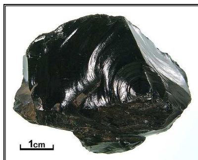
Photographie 2: Structure vitreuse (source:j2al.bloguez.com)
